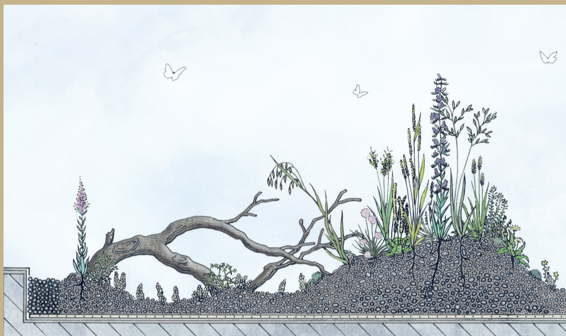
Sezione di massima (fuori scala) di un tetto sottoposto a un intervento di vegetalizzazione estensiva, con microtopografia e legno secco per gli insetti Fonte: ZHAW, Institut für Umwelt und Natürliche Ressourcen
