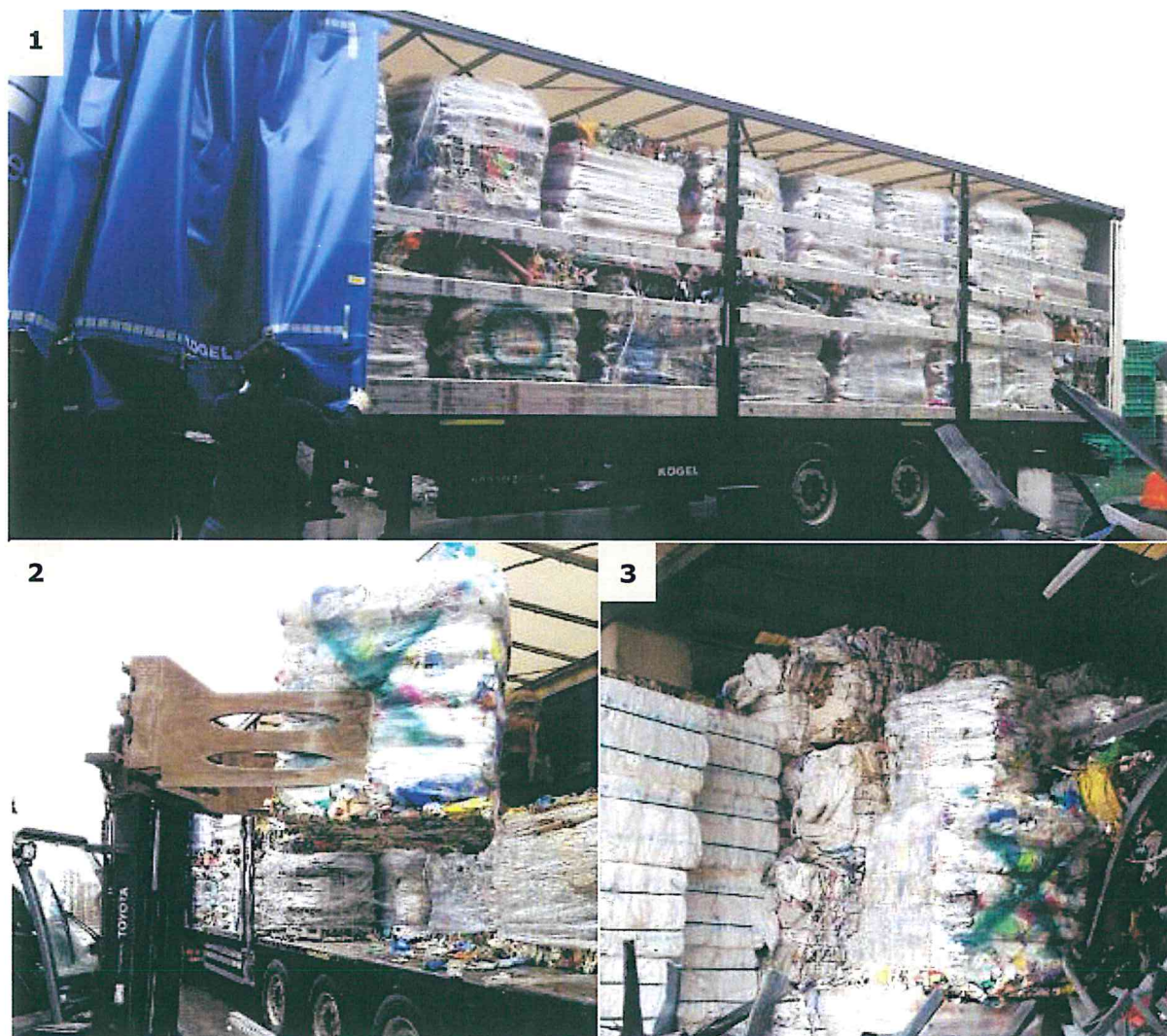
Figura 7: Operazioni di scarico del trasporto (1 - revisione del carico con particolare del colle di plastica dura; 2 - recupero colle di flaconi; 3 - deposito temporaneo per tipologia di materiale).
