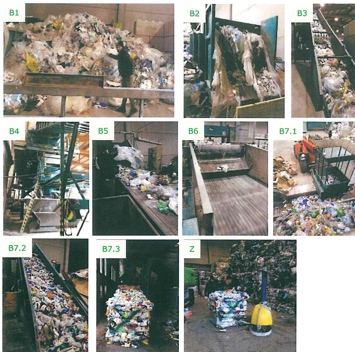
Figura 5: Riepilogo del processo all'interno dell'impianto Fratelli Puricelli SA per i flaconi (B1 – separazione manuale; B2 – dosatore a "pinne di squalo"; B3 – nastro con aspiratore di polveri e vaglio; B4 – vaglio vibrante; B5 – separazione manuale; B6 – fine nastro; B7.1 – caricamento del nastro per pressa; B7.2 – ingresso della pressa; B7.3 prodotto pressato segnato per tracciamento; Z – imballaggio).
