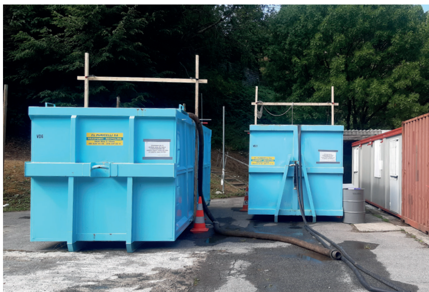
I due cassoni da 30m 3 con l'acqua ad uso irriguo messi a disposizione in zona campo sportivo Nebian.
