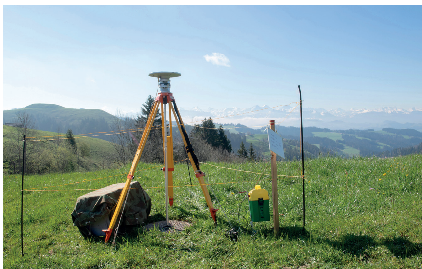
Durante 48h l'antenna GNSS riceve i segnali satellitari per calcolare la posizione esatta di un punto di controllo. (Foto: Swisstopo)
