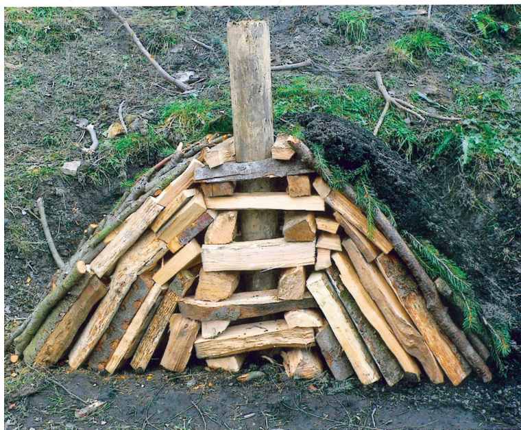
Sezione di un « puiatt » costruito a scopo didattico.
