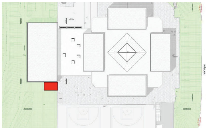
Planimetria del Centro scolastico; in rosso il nuovo locale interrato quale deposito.
